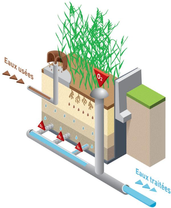
Principe de fonctionnement d'un filtre à sable
